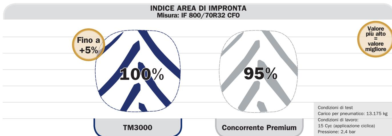
La maggiore area di contatto del TM3000 riduce significativamente il compattamento del terreno. L'ampia area di impronta garantisce un migliore galleggiamento rispetto ai concorrenti,
