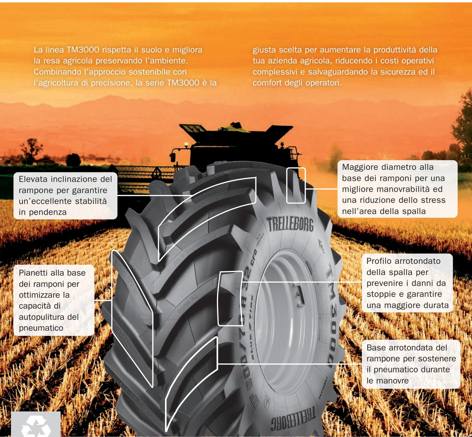
Elevata inclinazione del rampono per garantire un'eccellente stabilità in pendenza
