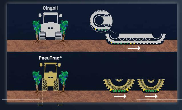
Larghezza ridotta del trattore e peso inferiore del 20% rispetto a un equipaggiamento con cingoli, per la protezione delle radici
