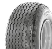
Pneus sans chambre à air, avec indice de charge/vitesse, recommandés pour les remorques.
