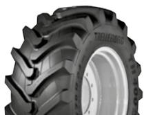
Ligne radiale conçue pour équiper les télescopiques, tractopelles et chargeurs compacts. Le TH400 est la solution parfaite pour des applications à la fois agricoles et semi-industrielles.
