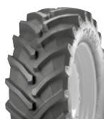
Avec ses performances exceptionnelles au champ et sur route, le TM800 a été développé pour les tracteurs de forte puissance. Une excellente traction, une capacité de charge supérieure à vitesses élevées, une réduction du tassement du sol, un confort de conduite et une excellente longévité telles que soient les conditions de travail : tout cela améliore la productivité de vos opérations agricoles.
