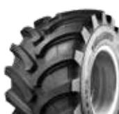
Pneu spécialement conçu pour le débardage des grumes, doté d'une résistance maximale aux lacerations. Il offre une excellente longévité dans les conditions d'exploitation les plus intensives. La structure particulièrement résistante des nappes protège la carcasse contre les souches, rochers et blocs de pierres.
