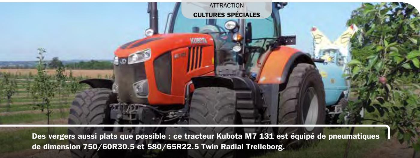
Des vergers aussi plats que possible : ce tracteur Kubota M7 131 est équipé de pneumatiques de dimension 750/60R30.5 et 580/65R22.5 Twin Radial Trelleborg.
