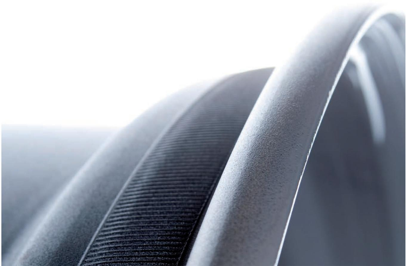
El moleteado ha sido incrementado en un 50% en comparación con la versión estándar. Esto, combinado con la pintura de fricción especial, maximiza las características de fricción de la llanta al montar el neumático.
