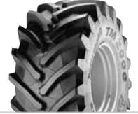
Radialreifen für Erntemaschinen und Mähdräpfer. Hohe Tragfähigkeit, durch einen stabilen Karkassenaufbau und eine große Stollenbreite. Widerstandsfähiger Reifen mit maximaler Zuverlässigkeit bei allen Einsätzen unter allen Bedingungen.
