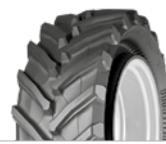
Er kombiniert die erstklassigen Eigenschaften der bewährten Landwirtschaftsreifen von Trelleborg mit einer neuartigen Seitenwand in CupWheel Bauweise. Das innovative Omega-Design der Seitenwand verbessert die Tragfähigkeit der Karkasse. Gleichzeitig steigt die Flexibilität, wodurch eine besonders große Aufstandsfläche mit sehr geringem Bodendruck entsteht, was die Verdichtung minimiert.
