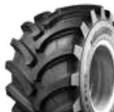
Speziell für Rückearbeiten, maximal widerstandsfähig gegen Risse und Stichverletzungen. Langlebigkeit bei härtesten Einsatzbedingungen. Verstärkte Kordlagen schützen die Karkasse gegen Baumstümpfe, Steine und Felsen.
