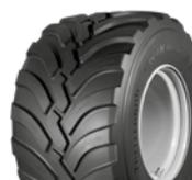
Implementreifen in VF- Bauweise mit Stahlgürteln für Langlebigkeit und eine überlegene Leistung im Feld- und Straßeneinsatz. Im Gelände besticht er durch seine hervorragende Qualität, seine Flotation und die Selbstreinigung. Auf der Straße bietet er ein gutes Fahrgefühl und einfaches Handling bei gleichzeitig erhöhter Fahrstabilität und gutem Fahrverhalten.
