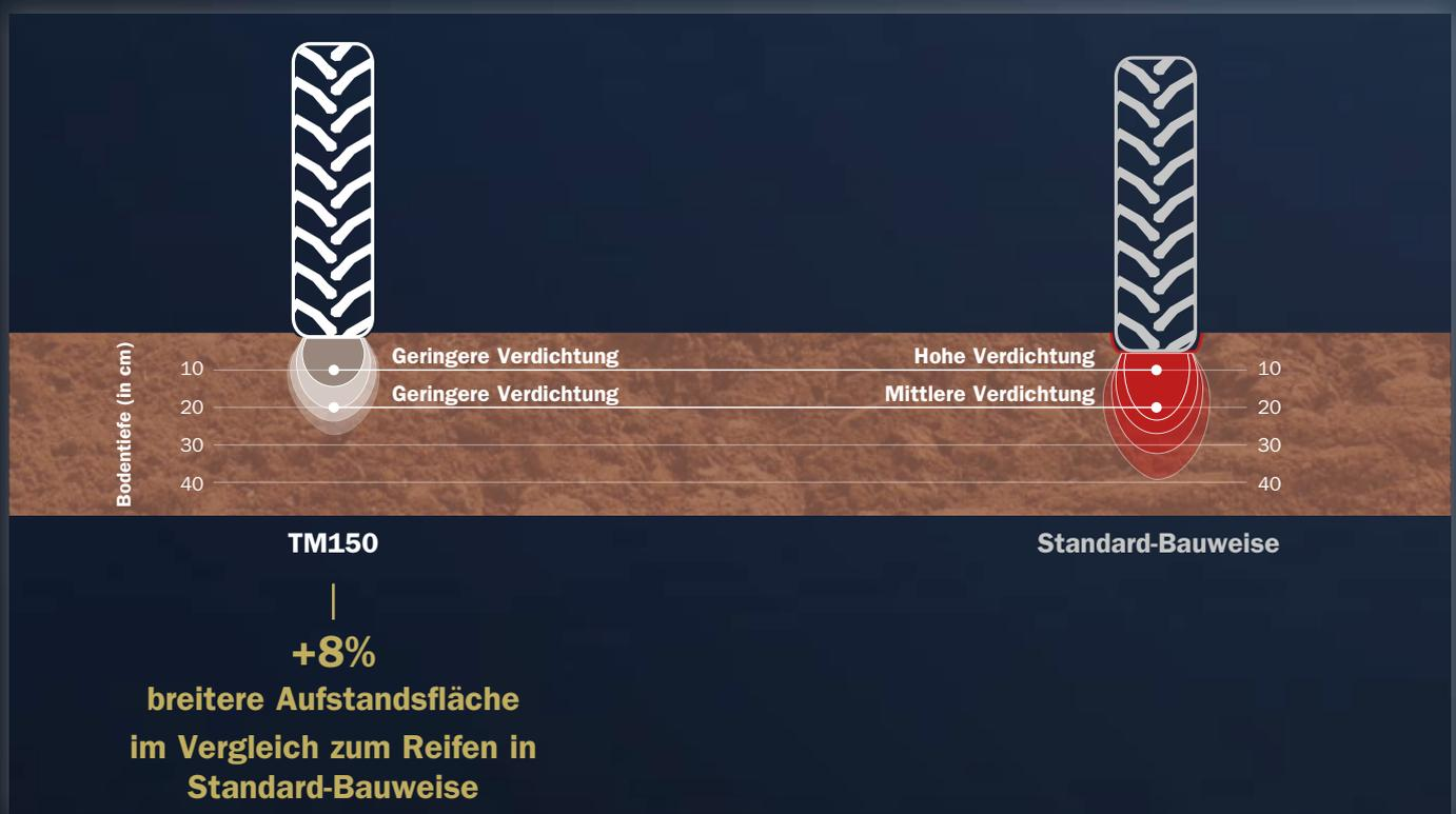
Je größer die Bodentiefe, desto höher ist im Vergleich die Verdichtung durch einen Reifen in Standard-Bauweise. In 20 cm Tiefe ist die Bodenverdichtung durch den TM150 noch „gering“, während der Reifen in Standard-Bauweise in der gleichen Tiefe den Boden schon „mittelgradig“ verdichtet.
