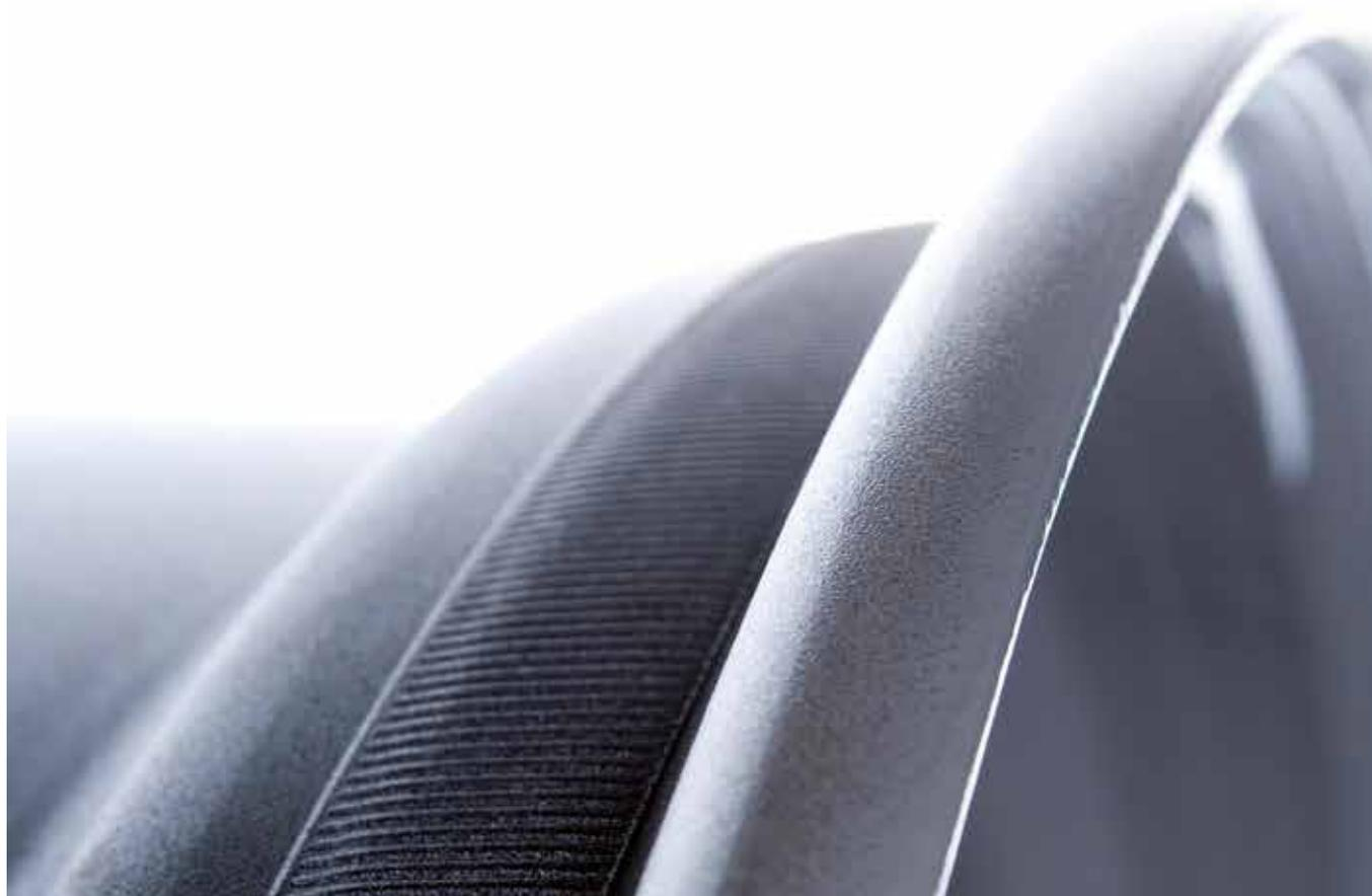
O recartilhamento foi aumentado em 50% em comparação a versão padrão. Isto combinado com a tinta de fricção especial, maximiza as características de fricção do aro quando o pneu é montado.
