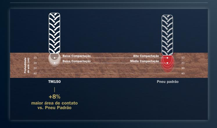
O grau de compactação, quando o pneu é apronfudado no solo, piora rapidamente utilizando um pneu padrão. A 20cm de profundidade, o TM150 mantém uma compactação "baixa", enquanto o pneu padrão já apresenta uma compactação "média".
