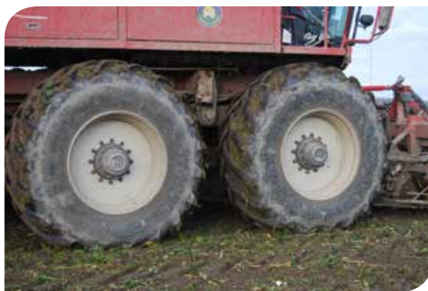
De TM3000 kunnen werken met een bandenspanning van amper 1,3 bar, waardoor de bodemdruk aanzienlijk beperkt wordt.
