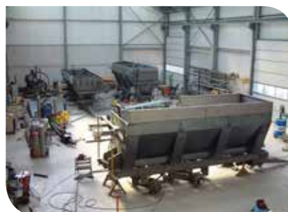
De kalkstrooiers worden gebouwd in de werkplaats van Ciney
