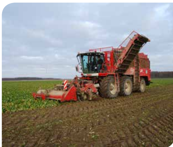
De TM3000 kunnen werken met een bandenspanning van amper 1,3 bar, waardoor de bodemdruk aanzienlijk beperkt wordt.
