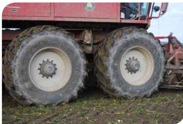
**Les TM3000 peuvent être gonflés à une pression de seulement 1,3 bar, ce qui limite grandement la compaction du sol.**
