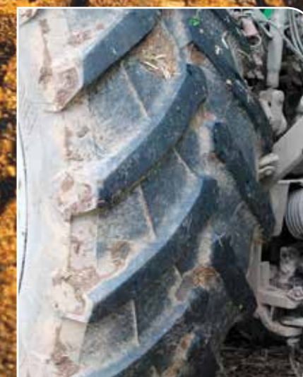
Efter mer än 70 000 kilometer på landsvägen bedömer Preben Jensen att det är ca 50 procent mönster kvar på de båda bakdäcken.
