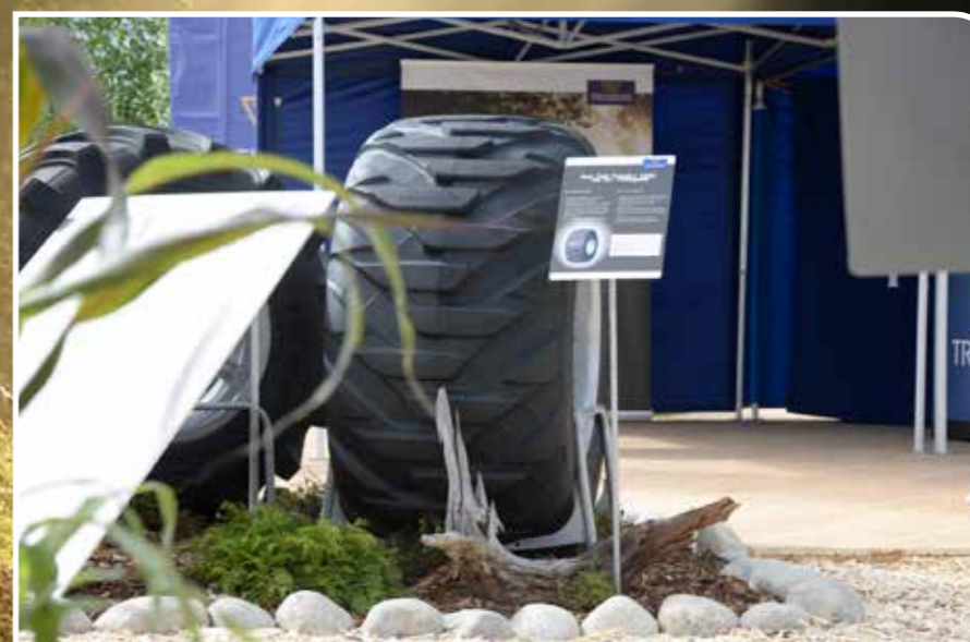
De tvärgående spåren i drivmönstret på T480 samt den platta däckprofilen ger överträffat bandgrepp och kompatibilitet.
