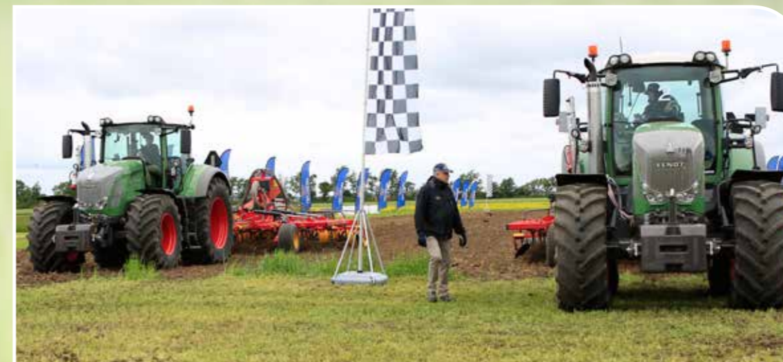
Fendt 828-traktorn med TM1000 High Power-däck och luftryck 0,8 bar har gått i mål, cirka 4 sekunder snabbare än traktorn med TM900 High Power-däck med luftryck 1,5 och 1,6 bar fram respektive bak.
