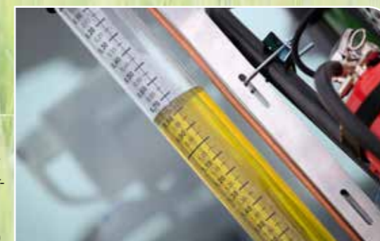
Drivstofforbruket ble målt ved hjelp av et rør som var montert på hver av de to traktorene. Traktoren med TM1000 High Power-dekk og 0,8 bar i dekkene brukte hele 28 % mindre drivstoff enn traktoren med TM900 High Power-dekk og et høyere trykk.
