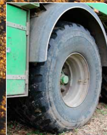
Spylevognen kjører med Trelleborg Twin Radial i dimensjon 560/60R22.5. Den østjyske gründeren har bare lovord å si om dekkene som bærer godt på våt mark, har god selvrensning og stabilitet ved kjøring på vei.
