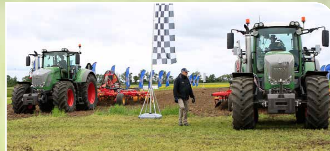
Fendt 828-traktoren med TM1000 High Power-dekk og et lufttrykk på 0,8 bar har gått i mål ca. 4 sekunder raskere enn traktoren med TM900 High Power-dekk og lufttrykk på 1,5 og 1,6 bar henholdsvis foran og bak på traktoren.
