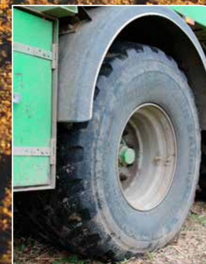
Spulevognen er på akslerne monteret med Trelleborg Twin Radial i dimensionen 560/60R22.5. Den østjyske entreprenør roser dækkene for at bære godt oppe på våde marker, god selvlrensning og for stabilitet på landevejen.
