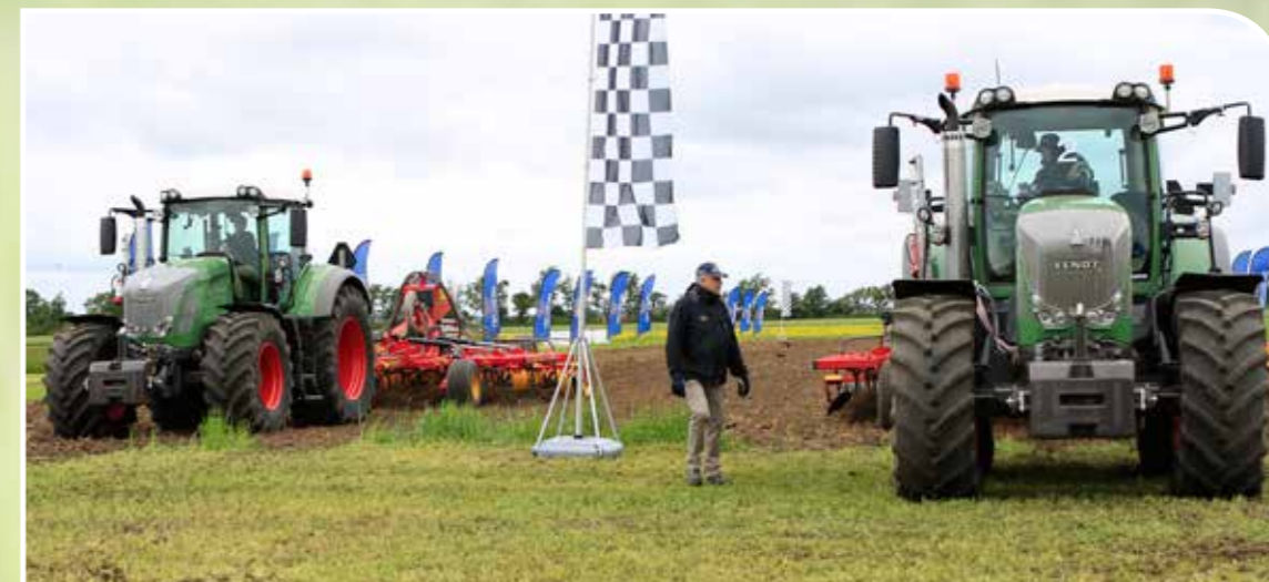
Fendt 828-traktoren med TM1000 High Power-dæk og lufttryk på 0,8 bar er nået i mål, cirka 4 sekunder hurtigere end traktoren med TM900 High Power-dæk og et lufttryk på 1,5 og 1,6 bar på hhv. det forreste og bageste dæk.
