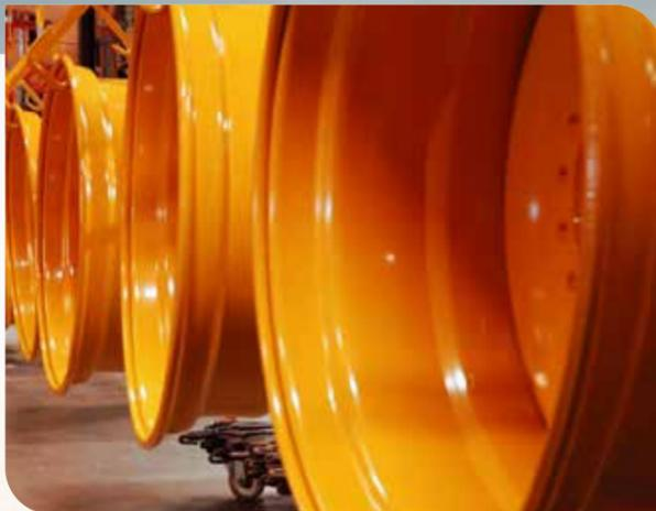
Pensée spécifiquement pour les pneus agricoles de grand volume, cette jante de nouvelle génération facilite le montage et le gonflage, notamment à basse pression. Résultat : un gain de temps, une mise en œuvre plus simple et une meilleure efficacité au champ. Autant d'éléments qui comptent dans le quotidien d'une exploitation. Mais l'innovation va bien
