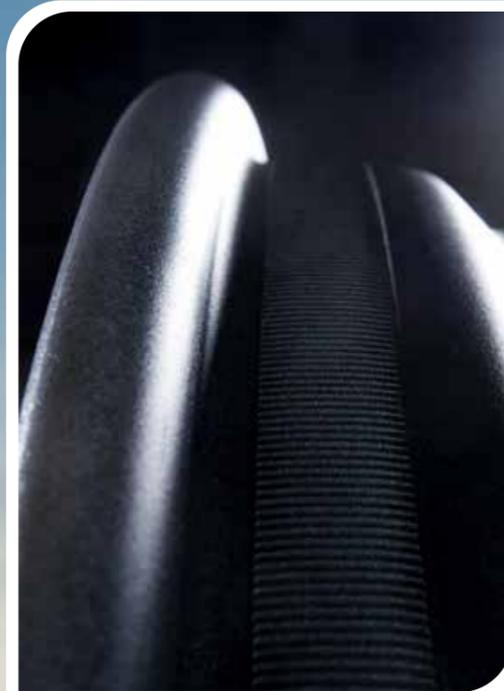
Le moletage de la jante a été augmenté de 50 % par rapport à une version standard. Associé à une peinture spéciale à effet agripante, ce renfort permet d'optimiser l'adhérence entre la jante et le pneu lors du montage.
